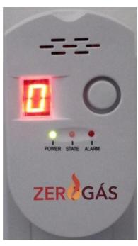
O Detector de Gás, **ZEROGÁS** é um equipamento que deve ser instalado na parede de cozinhas, salas e locais confinados em geral, tendo como função detectar a presença de gases cuja concentração volumétrica está ascendente ao limite inferior de explosividade (LIE).
